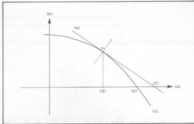
Figura 2 - (a) eixo das abcissas; (b) eixo das ordenadas; (c) gráfico da função; (d) primeira aproximação; (e) reta tangente à função para o ponto (d); (f) segunda aproximação; (g) raiz da função
